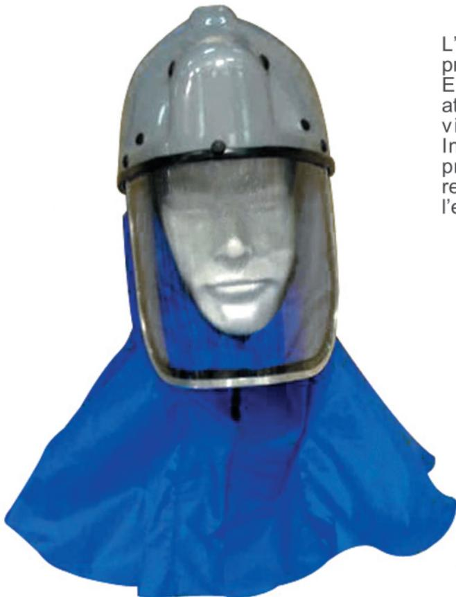
L'Air Filter, è un innovativo respiratore, per la protezione da polveri e gas. E' dotato di una turbina che aspira l'aria attraverso i filtri e la convoglia (depurata) sulla visiera evitandone l'appannamento. Inoltre il continuo flusso d'aria crea una pressione positiva che elimina ogni sforzo respiratorio garantendo comfort e impedendo l'entrata di aria contaminata.
